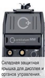
Складная защитная крышка для дисплея и органов управления.
